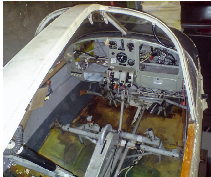
Sicherheit geht vor Alle Schläuche und Instrumente werden überprüft und erneuert. Die Maschine soll ein neues Funkgerät und einen neuen Transponder erhalten
