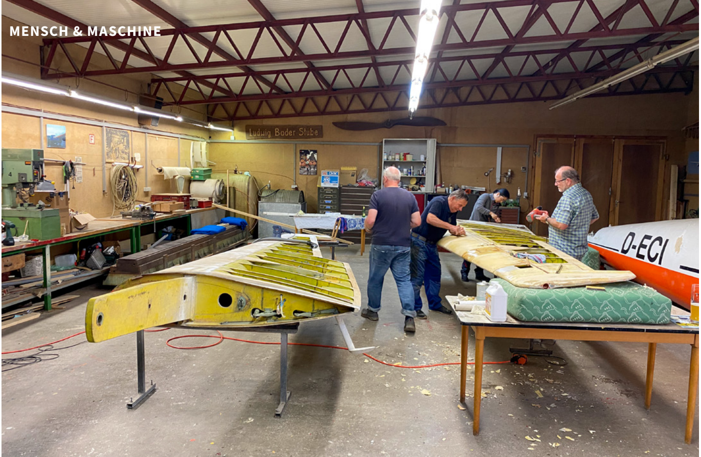
Feinarbeit Die Holzbeplankung darf beim Bearbeiten der Oberfläche nicht beschädigt werden. Die Verleimungen der Rippen muss sorgfältig geprüft werden
