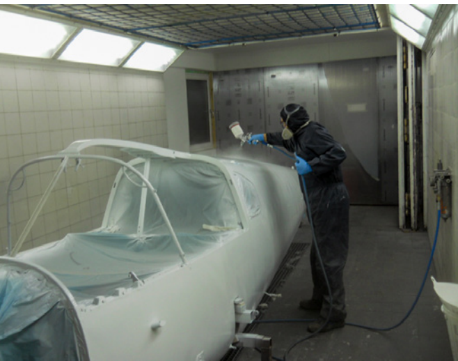
Sprühalarm Frühere Restaurierungen mussten grundiert und lackiert werden. Dank Oratex entfällt das jetzt
